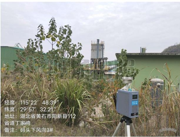
码头厂界下风向 7#无组织排放废气检测点位
