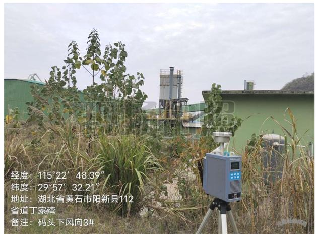
码头厂界下风向 8#无组织排放废气检测点位
